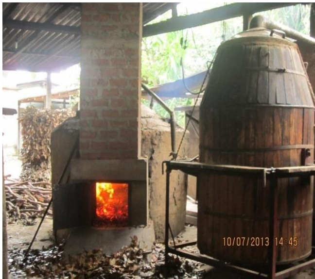
ඡායාරූප අංක 3.2 සිසිලන පද්ධතිය හා තෙල් වෙන් කර ගැනීමේ උපකරණ කට්ටලය
